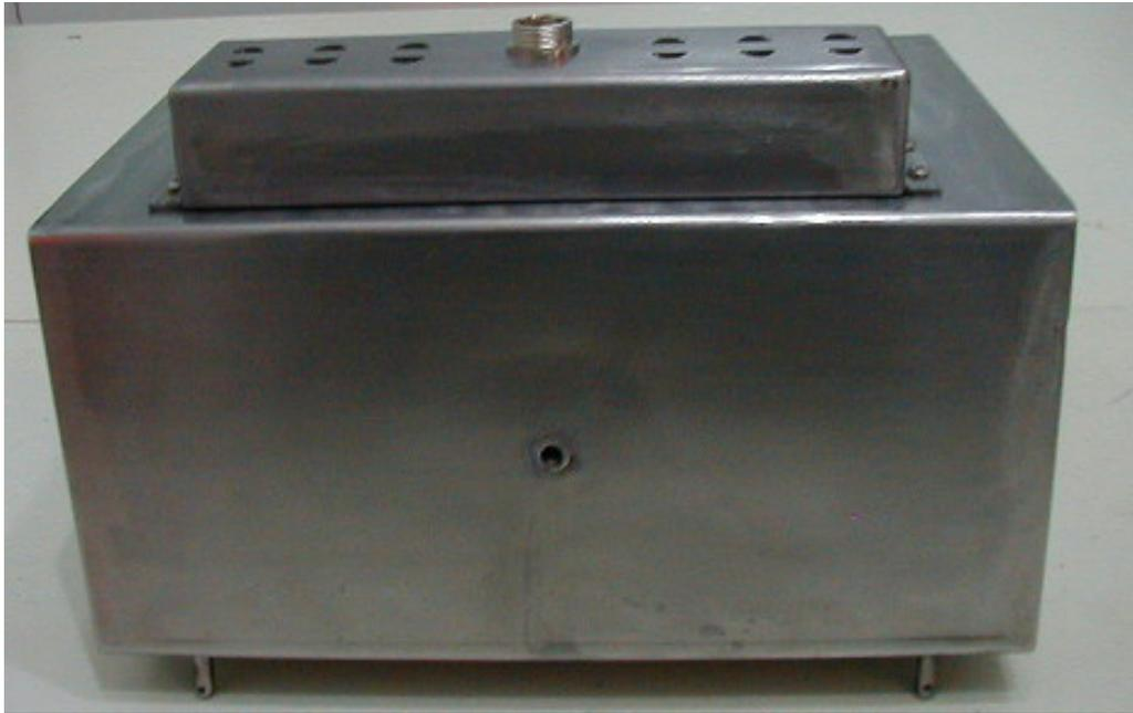
华美陶瓷隧道窑用耐高温温度测试仪外形
